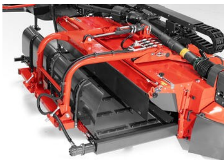
Při použití kondicionéru lze kombajn vybavit instalací dopravních pásů pro formování řádků. Ty umožňují rychlejší sklizeň, a protože nejsou k dispozici žádné další postupy, snižuje se ztráta sušiny a vstup popela do píce.
