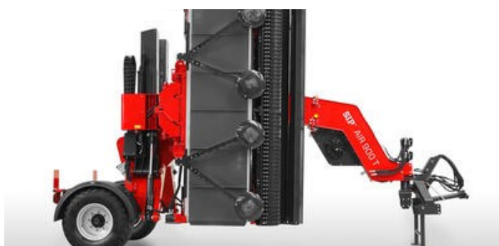
Kompaktní přepravní poloha s krátkým rámem umožňuje pohodlnou manipulaci se strojem a stabilitu při přepravě.
