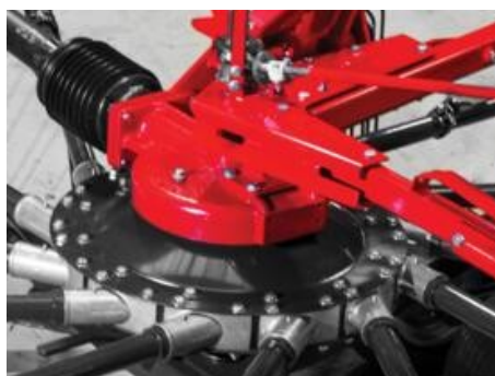
Hydraulicky nastavitelné rotory se pohybují nezávisle na podvozku, takže je zajištěno perfektní kopírování terénu 3D. Pružinové prsty se pohybují paralelně s terénem.
