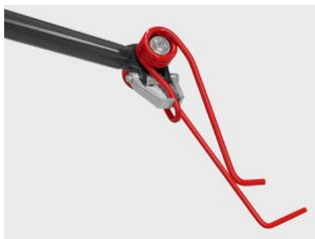
Háčkovitý tvar pružinových prstů (nadstandardní výbava) umožňuje zvedání píce ve dvou vrstvách, což zvyšuje účinnost rozhazování u modelů obracečů s větším průměrem rotoru.
