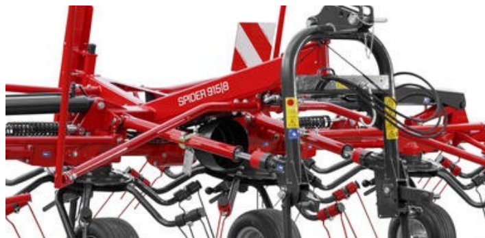
Otočná přípojovací konzola se stabilizátory umožňuje snadné kopírování stopy traktoru.
