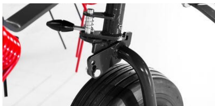
Nastavitelná kola s rozhozem podél hranice pole a nastavitelnou výškou rotoru (pouze s flexibilním závěsem).
