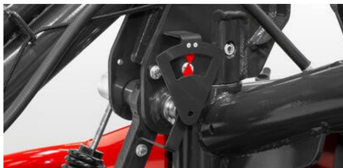
Indikátor pracovní výšky pro optimální odlehčení žací lišty při sekání a rovnoměrný tlak na povrch.
