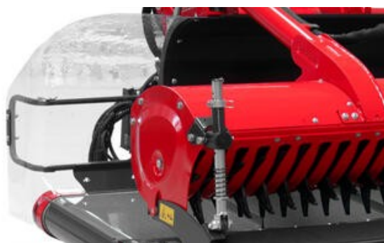
Průhledné boční kryty zajišťují dobrou viditelnost proudění píce.
