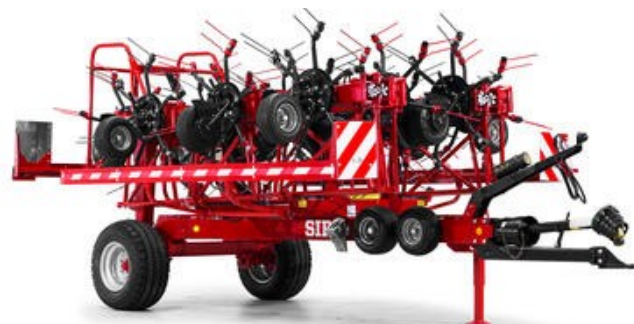
Kompaktní podvozek zajišťuje vynikající manévrovatelnost stroje při přepravě.
