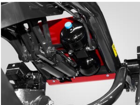
Systém dvojího válce a akumulátoru S-FLOW zajišťuje nezávislé a rychlé uvolnění žací lišty bez vlivu na traktor.
