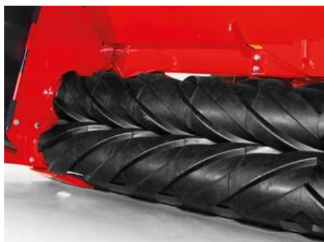
Profilované spirálové válce se otáčejí proti sobě a mačkají stébla podélně, čímž umožňují rychlejší vysychání.
