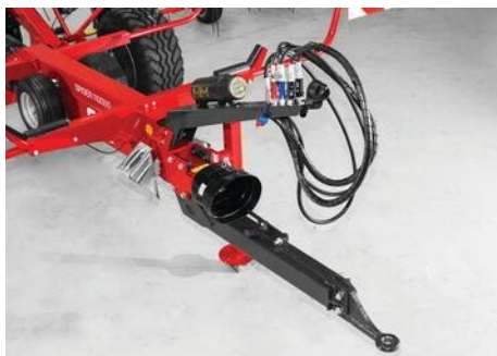
Nastavitelná oje s přepravním rámem pro rychlost až 40 km/h.
