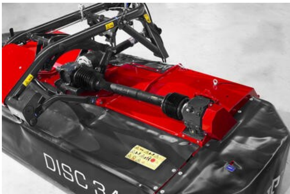
Pohon přes hřídel PTO a převodovku přímo na první disk
