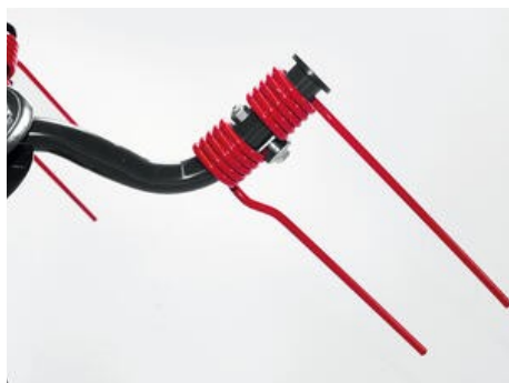
Pružinové prsty různé délky zabrání rýhování terénu a znečištění píce zeminou nebo pískem.
