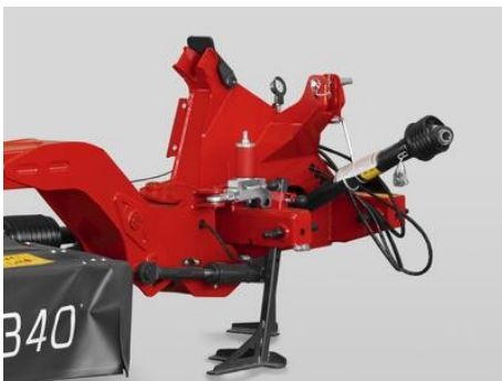
Robustní připojení s vyšším uložením při přepravě.
