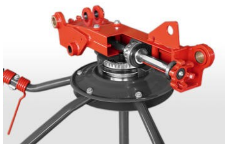
Robustní šestihranný pohon a ozubená kola s polotekutým mazivem zajišťují spolehlivost při intenzivním využívání na velkých plochách.
