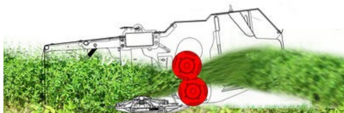
Tento typ úpravy se doporučuje pro sklizeň vojtěšky a jetele, jelikož nepoškozuje jemné lístky rostlin a zachovává nutriční hodnotu píce.
