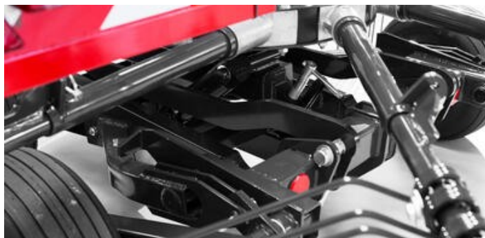
Snadné a jednoduché nastavení výšky rotoru pomocí závitového šroubu.
