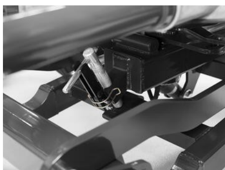
Snadné a jednoduché nastavení výšky rotoru pomocí závitového šroubu.
