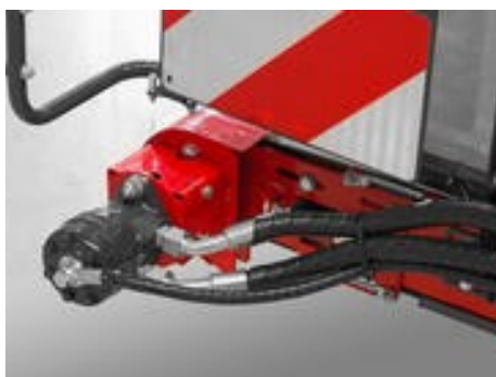
Směr a rychlost dopravníkového pásu se nastavují pomocí hydraulického motoru.
