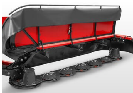
Snadná údržba díky snadnému přístupu k žacím lištám. Kryty a povrchy žacích lišt jsou navrženy s důrazem na omezení hromadění materiálu a snadné čištění.
