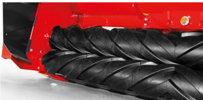
Profilované spirálové válce se otáčejí proti sobě a mačkají stébla podélně, čímž umožňují rychlejší vysychání.
