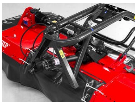
Připojovací konzola S-Flow s rychlým připojením kat. II zajišťuje vynikající schopnost reakce celé soustavy, dokonalé kopírování terénu a rovnoměrný přitlak na terén.
