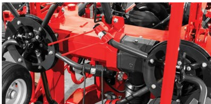
Inovativní dvojitá spojka pohonu chrání stroj před přetížením, a tím brání poškození pohonu stroje.
