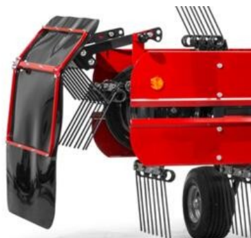
Píci lze obracet nebo shrnovat díky hydraulickému (nadstandardní vybavení) nebo mechanickému nastavení řádkovací plachty.
