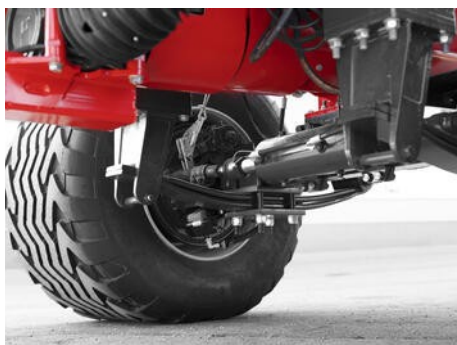
Při otáčení na okrajích zajišťuje řízený rám vynikající manévrovatelnost. Systém se automaticky zablokuje, což umožňuje bezpečnou přepravu a rychlejší přepravní rychlost.
