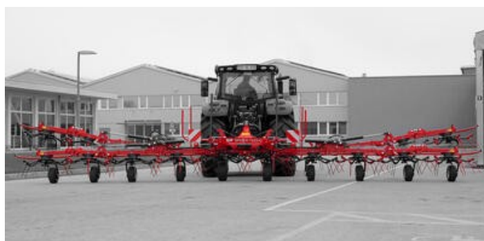
Dělené rotory umožňují dokonalé kopírování i složitého terénu.
