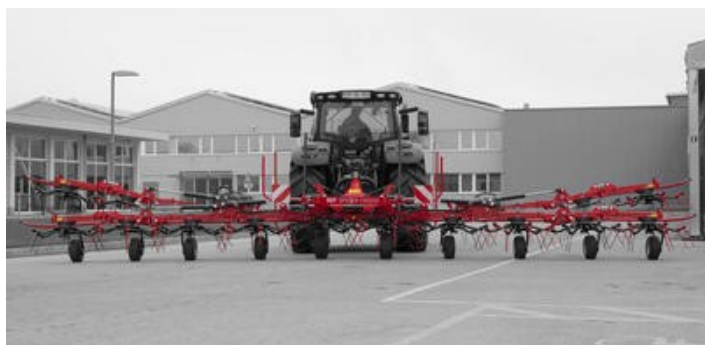
Modulární konstrukce jednotlivých připojených rotorů umožňuje široký záběr vertikálního kopírování terénu.
