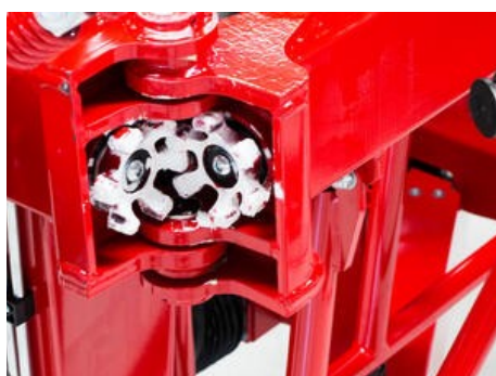
Zubová spojka na každém závěsu pro hladký a tichý chod a snížení zatížení.
