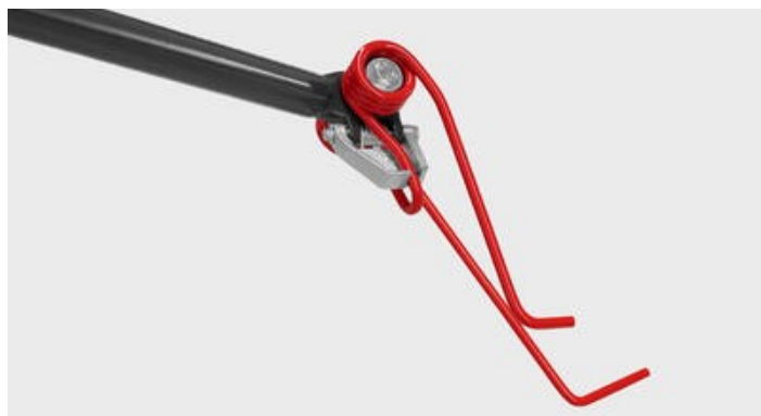
Háčkovitý tvar pružinových prstů (nadstandardní výbava) umožňuje zvedání píce ve dvou vrstvách, což zvyšuje účinnost rozhazování u modelů obrabečů s větším průměrem rotoru.
