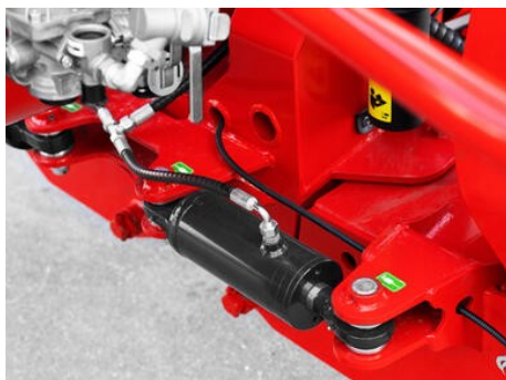
Hydraulická pojistka při najetí na překážku změni tlak v systému v případě najetí na překážku a žací lišty se najednou posunou dozadu a nahoru.
