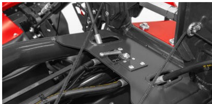
Individuální zvedání žací lišty s 2x SA připojením – jedno pro levou a jedno pro pravou žací lištu. Použití ventilu umožňuje současné nebo oddělené zvedání jednotek.
