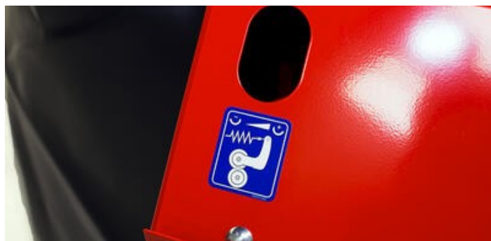
Díky nastavení intenzity kondicionéru lze nastavit přítlak válců podle množství a typu píce.
