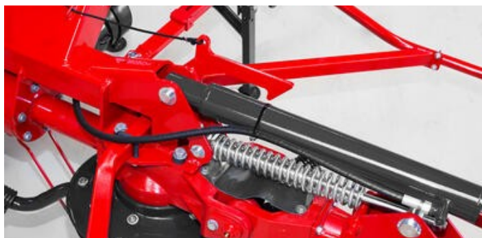
Hydraulické zvedání rotorů pro plynulé a rychlé skládání.
