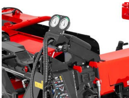
Žací kombinace je vybavena hydraulickým závěsným systémem, odděleným pro levou a pravou stranu, který lze snadno ovládat z traktoru.
