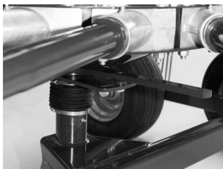
Nastavitelná řídící dráha \pm 15^\circ v závislosti na množství a vlhkosti píce.
