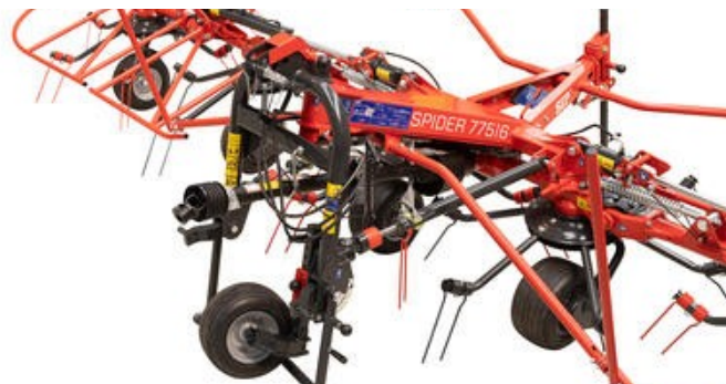
Pružná přípojovací konzola s třibodovou stabilizací nabízí flexibilní kopírování stopy traktoru a vyvážení při zvedání stroje.
