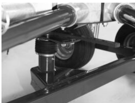
Nastavitelná řídicí dráha \pm 15^\circ v závislosti na množství a vlhkosti píče.
