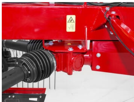
Pohon Y snižuje zatížení vývodového hřídele a zajišťuje dlouhou životnost.
