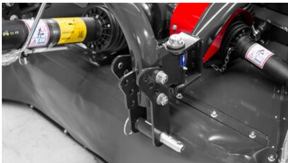
Univerzální třibodový závěs pro různé druhy speciálních horských traktorů.
