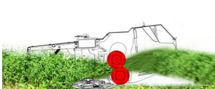
Tento typ úpravy se doporučuje pro sklizeň vojtěšky a jetele, jelikož nepoškozuje jemné lístky rostlin a zachovává nutriční hodnotu píce.
