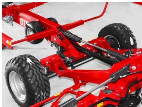
Patentované hydraulické nastavení vzdálenosti pružinových prstů od země podle výšky sečení a množství a vlhkosti píce.
