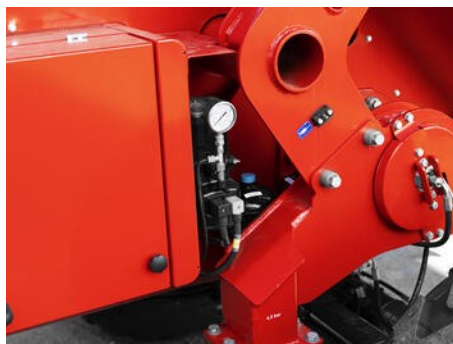
Centrální systém mazání je napojen na všechny části žacího stroje, které vyžadují mazání po každém sečení. Tento systém zkracuje dobu údržby.
