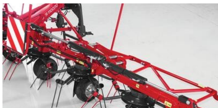
Inovativní hydraulický systém umožňuje provozování stroje v pracovní a přepravní poloze.
