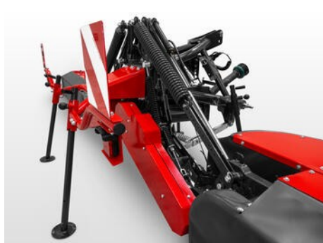
Odpružení a odlehčení žací lišty pomocí systému dvojitých pružin (DSS) zajišťuje rovnoměrný tlak na půdu a čistý řez.
