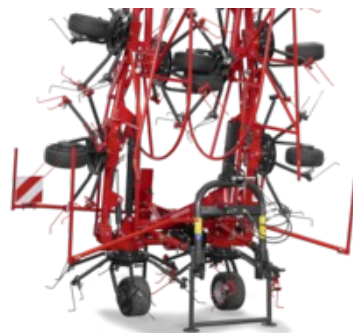
Rozměr středového páru kol je přizpůsoben většímu zatížení stroje uprostřed a umožňuje stabilní uložení stroje v přepravní poloze.
