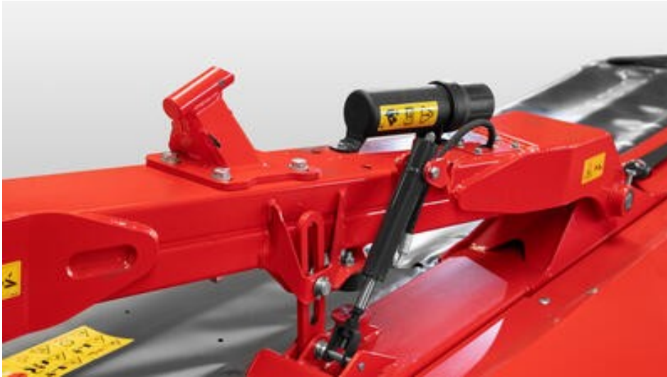
Hydraulická stabilizace umožňuje postupné zvedání žací lišty. Nejprve se zvedne vnitřní strana žací lišty a poté vnější strana.
