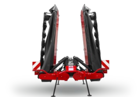
Čtyři opěrné nohy jsou integrovány do závěsu žacího stroje. Takto lze žací stroj kdekolí odpojit v přepravní poloze a je vždy připraven k řádnému zapřažení.
