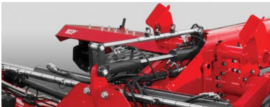
Rovnoměrné sečení travních porostů zajišťuje hydraulický systém centrálního nastavení výšky sečení všech čtyř žacích lišt najednou.
