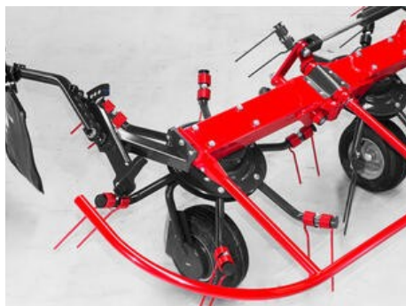
Propojené bezpečnostní lišty zajišťují stabilitu a pevnost stroje.
