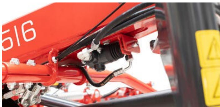
Systém SMART LIFT automaticky zablokuje a dodatečně zvedne vnější rotory při částečném zvedání, čímž umožňuje zvětšení světlé výšky.
