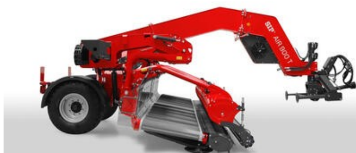
Kombinace flexibilního sběrného ústrojí malého průměru a tažených prstů snižuje znečištění řádků zeminou a kamínky.
