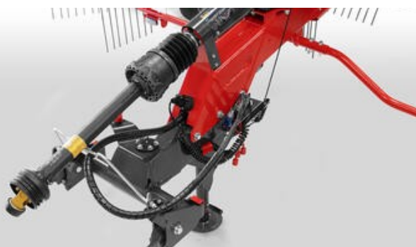
Otočný závěs spojený s robustním mechanismem řízení nabízí úhel natočení 77,5^\circ .
