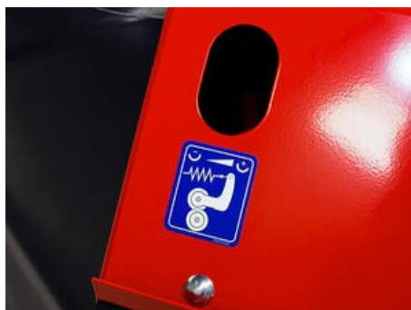
Díky nastavení intenzity kondicionéru lze nastavit přítlak válců podle množství a typu píce.
