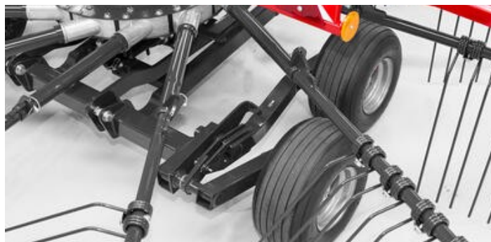
Přední rotory jsou vybaveny otočnou tandemovou nápravou SIP která umožňuje optimální kopírování terénu, vyšší pracovní rychlost a nižší přenos zatížení na stroj.
