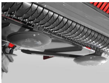
Volně otáčející se plazy jsou umístěny v těsné blízkosti sběrného ústrojí, takže pružinové prstí se jen zřídka dotýkají země, což snižuje opotřebení sběrného ústrojí a zajišťuje čistotu píce.
