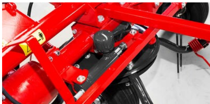
Všechny modely obracečů ze série ROBUST jsou standardně vybaveny centrálním hydraulickým ovládáním kol pro boční posun při práci na hranici pole.
