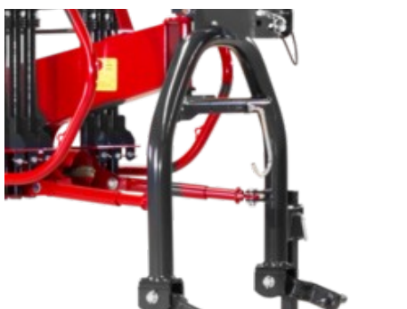
Díky kyvnému čepu a tlumicí vzpěře může stroj lépe kopírovat stopu traktoru.
