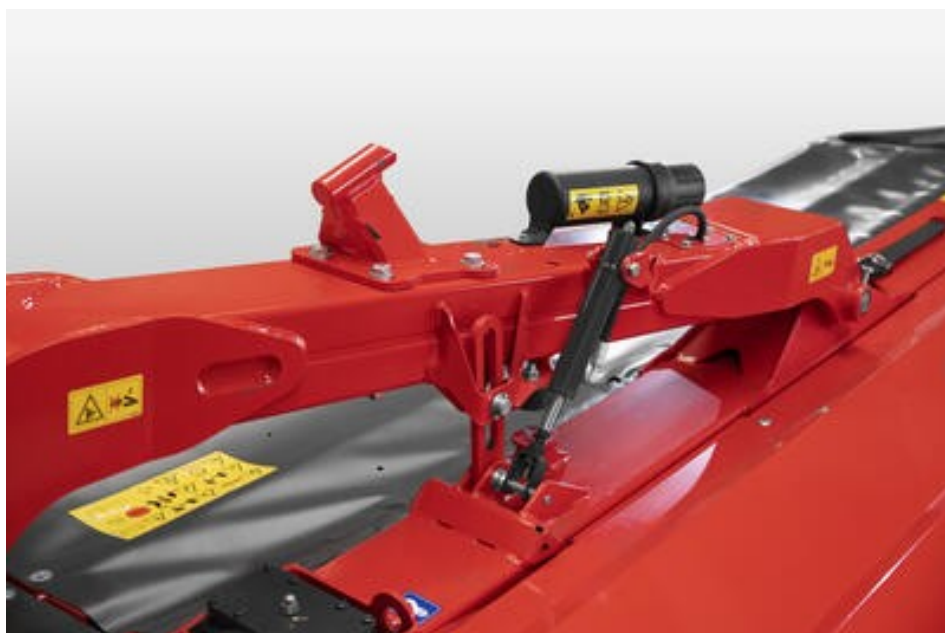
Hydraulická stabilizace umožňuje postupné zvedání žací lišty. Nejprve se zvedne vnitřní strana žací lišty a poté vnější strana.
