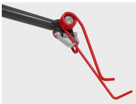
Háčkovitý tvar pružinových prstů (nadstandardní výbava) umožňuje zvedání píče ve dvou vrstvách, což zvyšuje účinnost rozhazování u modelů obracečů s větším průměrem rotoru.
