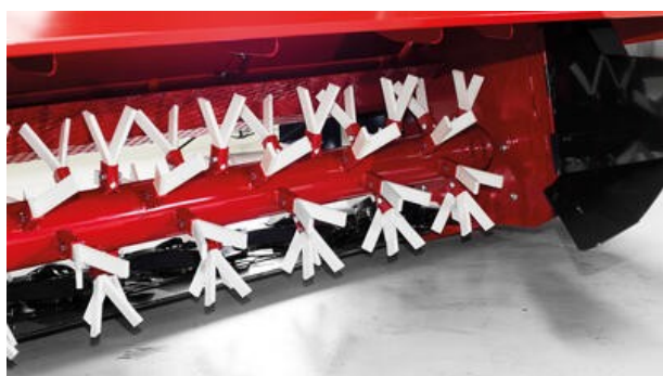
Pevné umělohmotné prsty škrábou a narušují epidermis stonků a lístků rostlin a lámou stonky.
