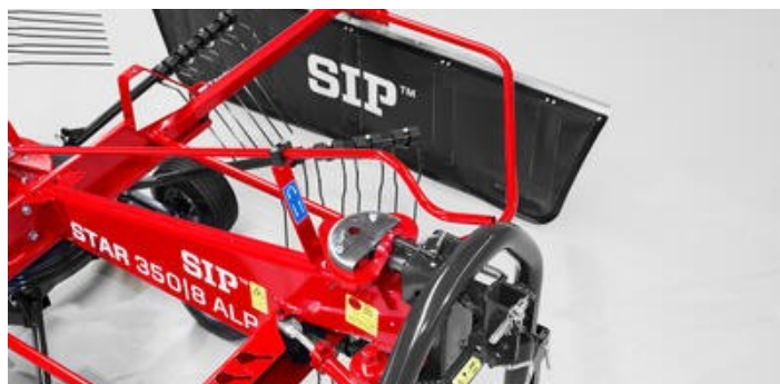
Nastavitelná šířka pracovního záběru podle množství píce a sběracího ústrojí.
