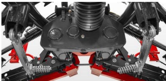
Samostatná mechanická ochrana žacích lišt. V případě nárazu lze posunout zpět pouze pravou nebo levou žací lištu, případně obě žací lišty současně. Úhel otevření žací lišty je 11°.
